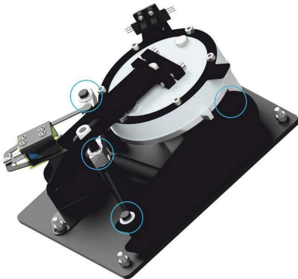
Рисунок 12.5.1 - Места смазки подвижных частей
