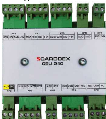
Рисунок 6.3.1 Контроллер управления турникетом «CBU-240»
