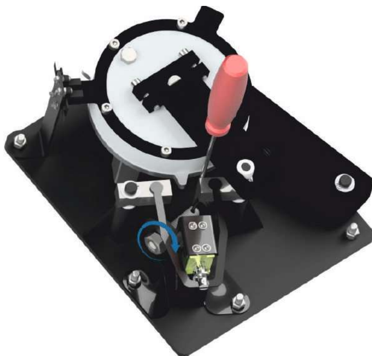
Рисунок 12.4.1 - Регулировка натяжения пружины доводчика
