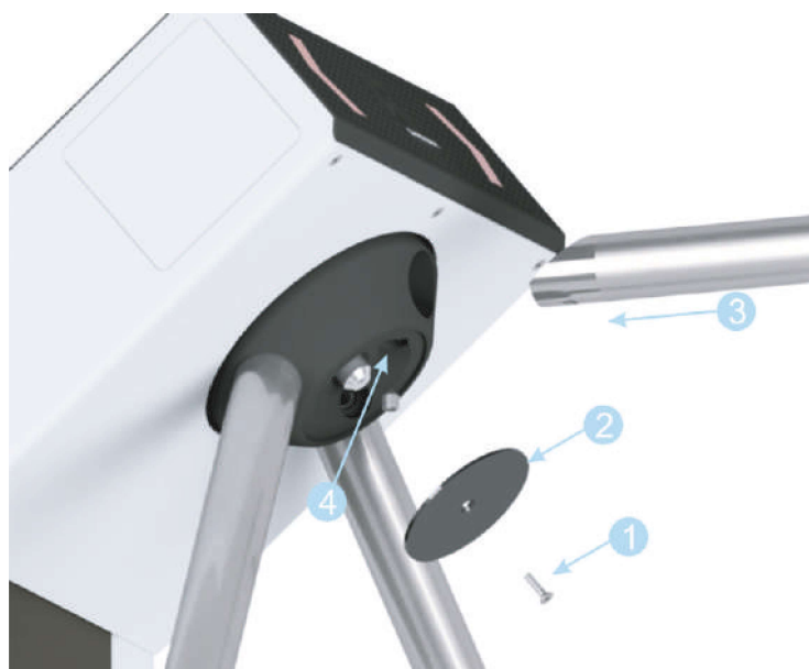
Рисунок 7.5.1 - Установка стандартной преграждающей планки
