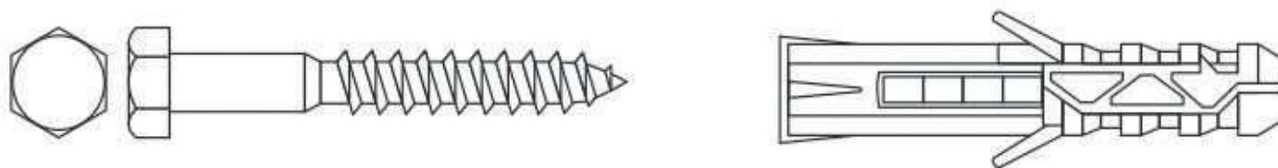
Рисунок 7.4.1 - Шуруп с шестигранной головкой «Глухарь» с дюбелем
