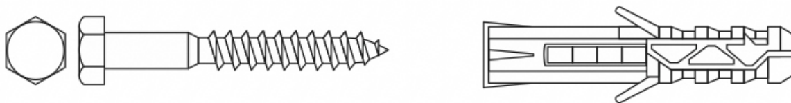
Рисунок 7.4.1 Шуруп с шестигранной головкой «Глухарь» с дюбелем
