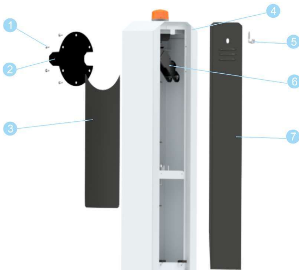
Рисунок 6.1.1 Внешний вид и состав корпуса шлагбаума
