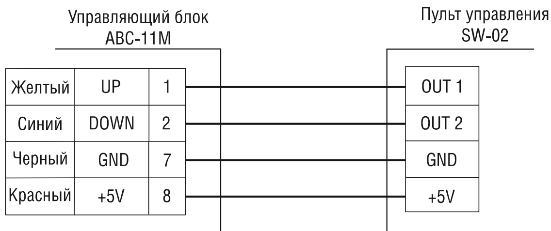
Рисунок 6.8.2 Схема подключения пульта дистанционного управления шлагбаумом «SW-02»
