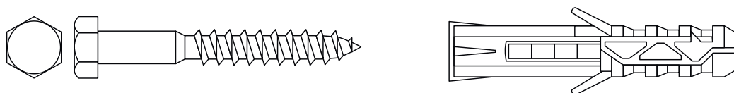
Рисунок 7.4.1 Шуруп с шестигранной головкой «Глухарь» с дюбелем
